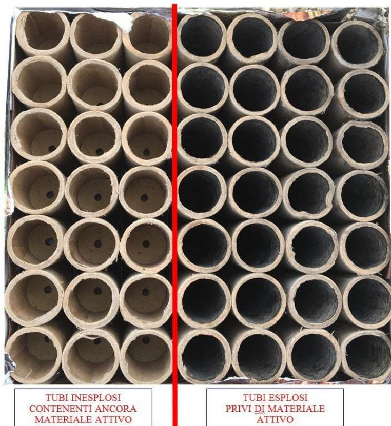
Qualora la batteria risulti essersi fermata, ovvero alcuni tubetti risultino inesplosi, non avvicinarsi per almeno 15 minuti, poi se possibile, utilizzando una bottiglia e posizionandosi lateralmente (mai sopra!!) alla batteria, bagnare abbondantemente con acqua tutta la superficie della batteria e allontanarsi. Recuperare dopo almeno 60 minuti e riportare al negozio di acquisto.
